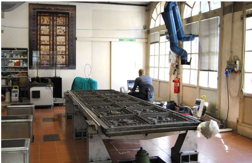
Figura 8: Estação de scanner 3D realizando o escaneamento das portas. Fonte: 14th century doors of the Florence Baptistery restored using 3D printing - 3D Printing Industry (acesso em 15/05/2022).
