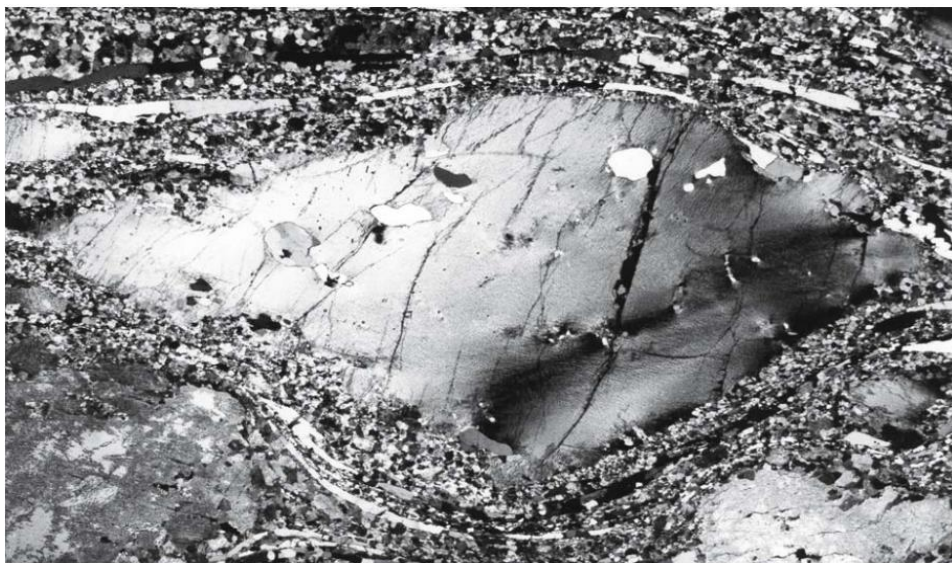
Figura 3.6 - Porfiroclasto de K-feldspato com extinção ondulante e matriz de feldspato e quartzo recristalizados. Destaque para os cristais de quartzo fortemente alongados formando fitas, “ ribbons ”. Três Rios, Estado do Rio de
