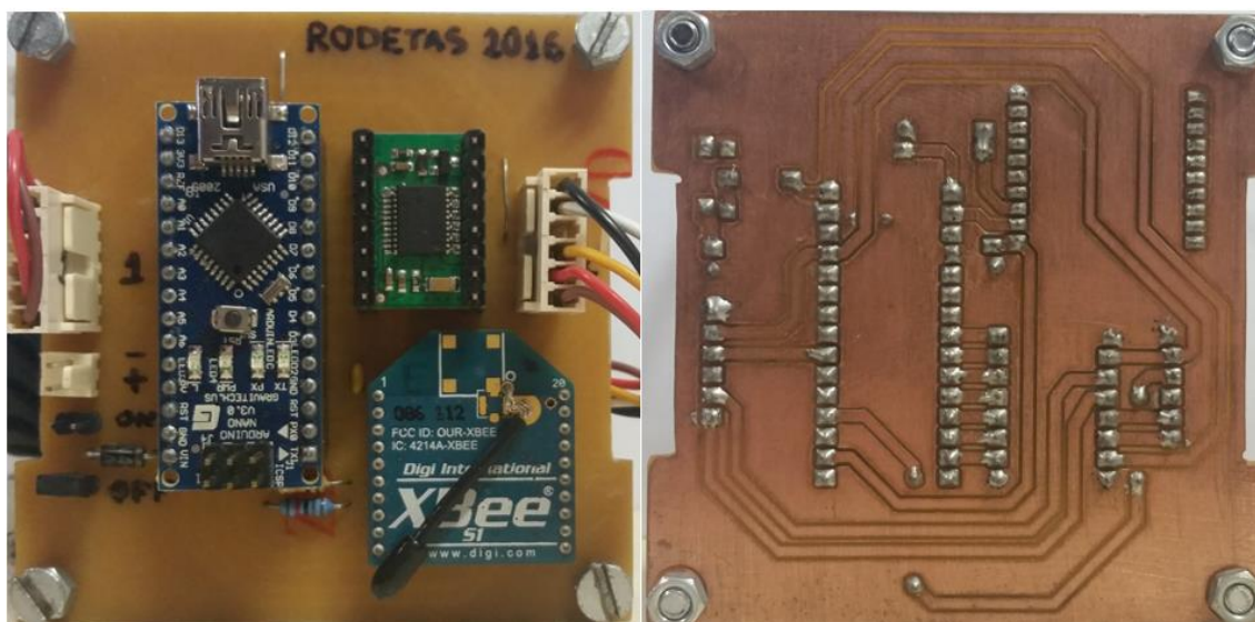
Figura 3.14 – Layout final da PCI produzidas em laboratório pela equipe Rodetas.
