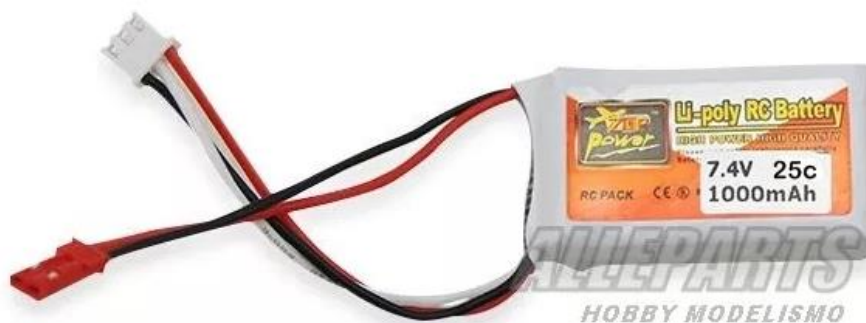
Figura 3.3 – Bateria utilizada na alimentação dos robôs de equipe Rodetas.
