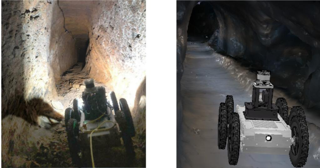
Figura 1 – Comparação do robô real dentro de uma mina em Ouro Preto e sua simulação referente (CID et al., 2020).
