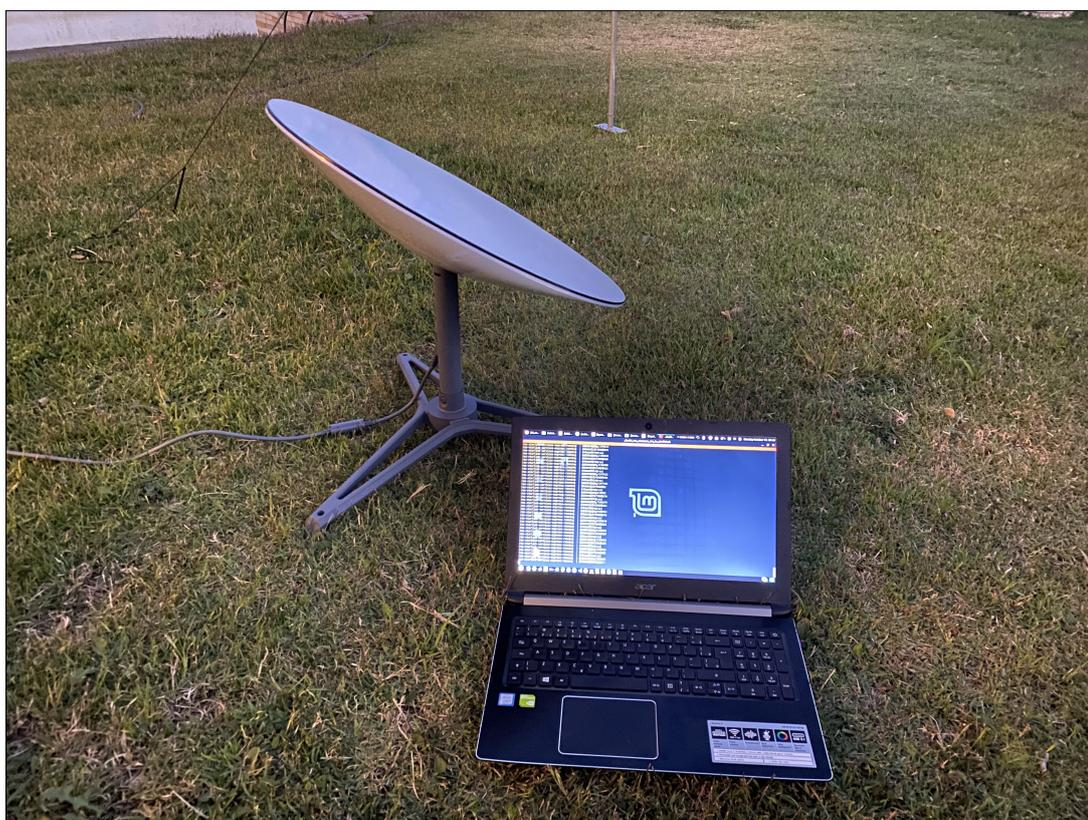
Figura 11 – Publicação dos dados ROS através da rede Starlink, notebook simulando dados do robô ao lado da antena de comunicação.
