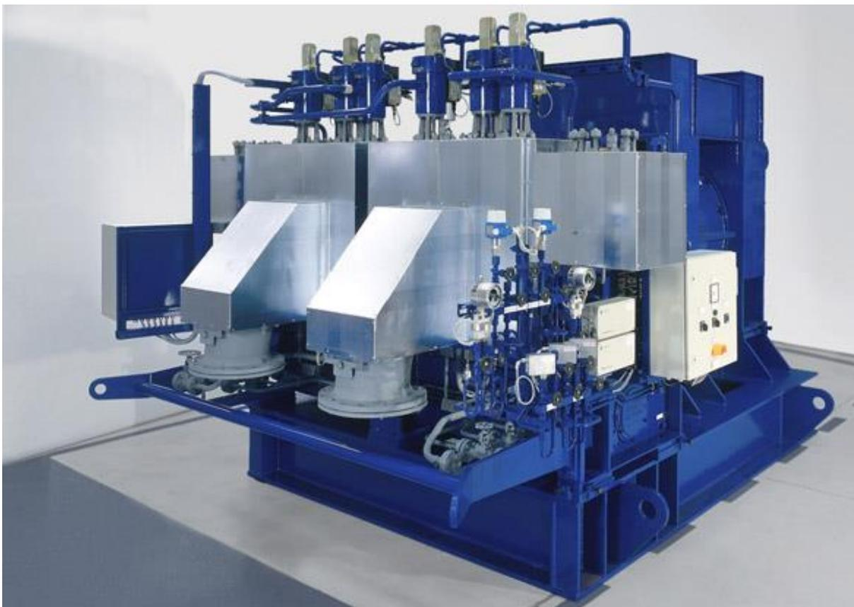
Figura 26 - Turbina de extração - condensação selecionada
