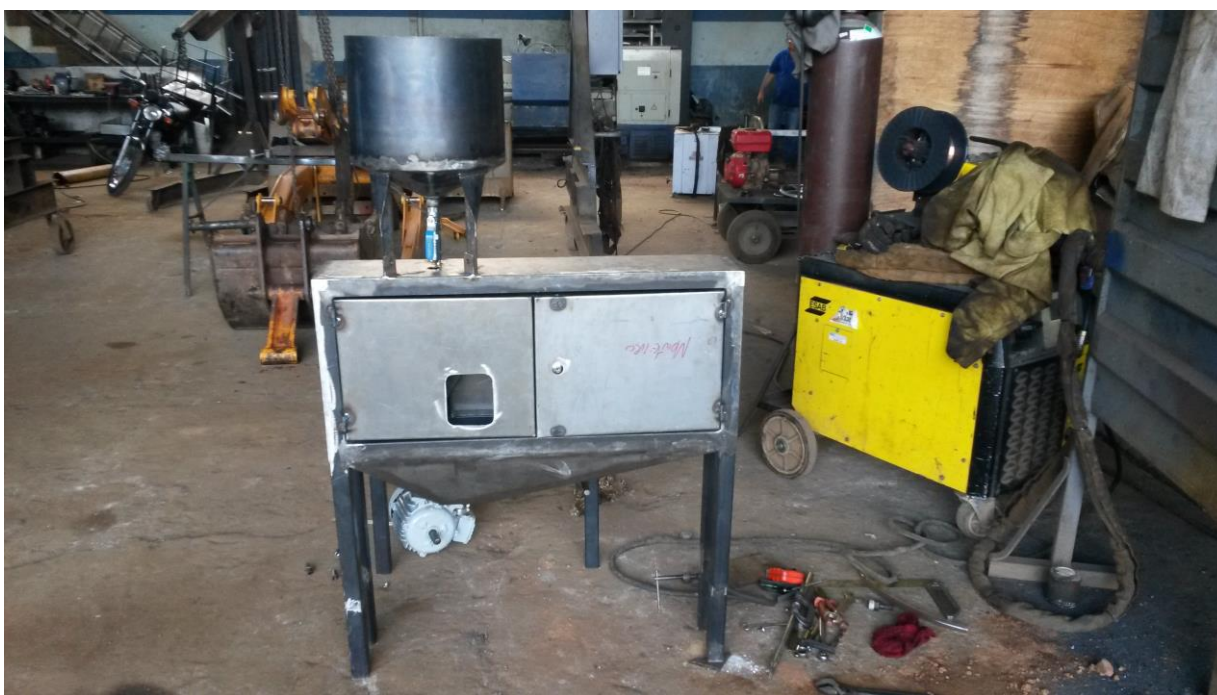
Figura 24: Estrutura em aço do Abrasômetro Fonte: Pesquisa direta (2016)
