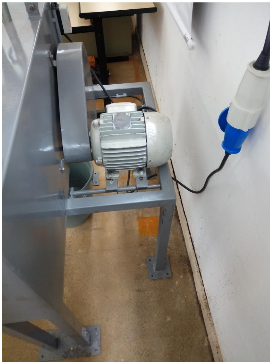
Figura 25: Sistema de acionamento motor polia Fonte: Pesquisa direta (2016)
