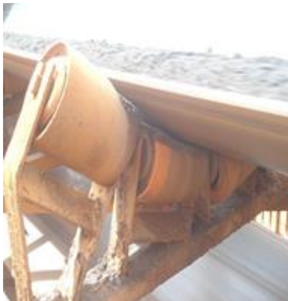
Figura 27: Configuração dos roletes de carga dentro do sistema do transportador de correias Fonte: Alvarenga (2014)
