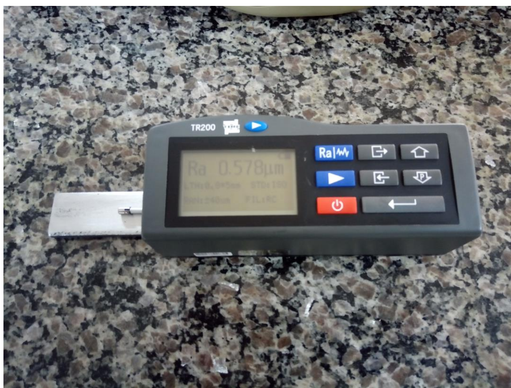
Figura 30: Leitura da rugosidade superficial com rugosímetro Fonte: Pesquisa direta (2017)
