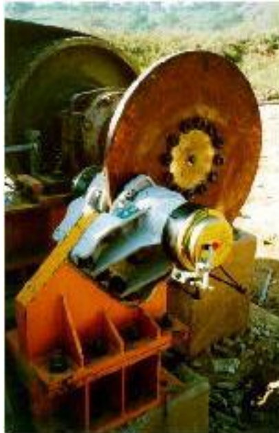
Figura 19: Sistema de freios de uma correia transportadora Fonte: Transportadores Contínuos para Graneis Sólidos – SACRAMENTO, R. C. F (2004)
