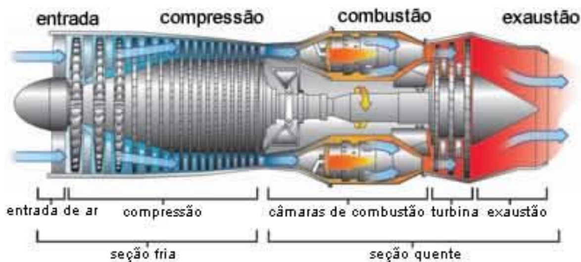
Figura 8. Turbina a gás mostrando seus componentes. Fonte: Cayuela, 2016.
