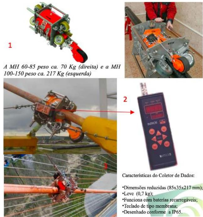
Figura 10: Etapas do processo de inspeção em ponte estaiada (INTRON, 2022).
