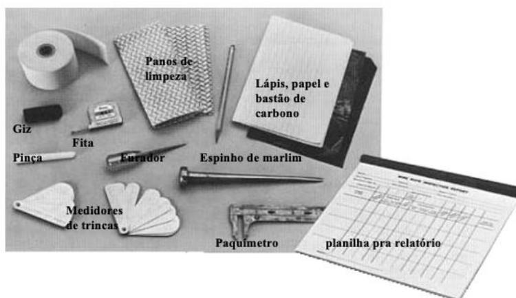
Figura 1: Ferramentas que são úteis para avaliar o cabo e um formulário para registrar as descobertas para fornecer um registro permanente (Adaptado de UNION, 2014).
