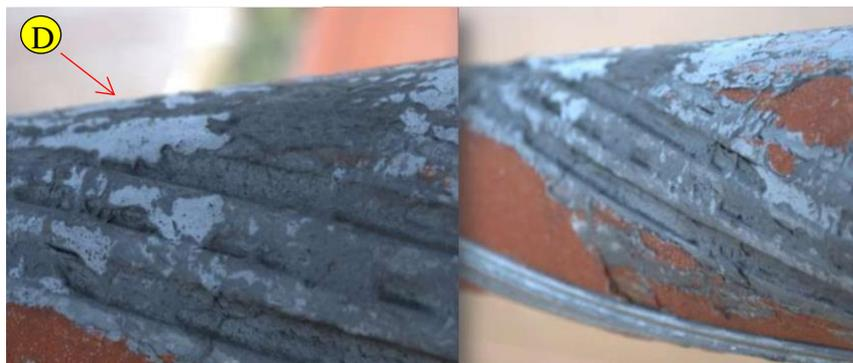
Figura 14: Imagem real da região D com defeitos LMA (INTRON, 2022).
