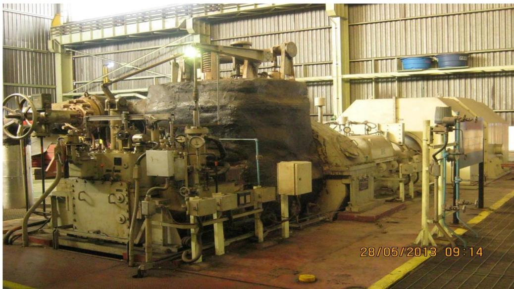
Figura 14: Foto da turbina a vapor Mitsubishi modelo 7EL-7 com vista externa do lado da turbina.
