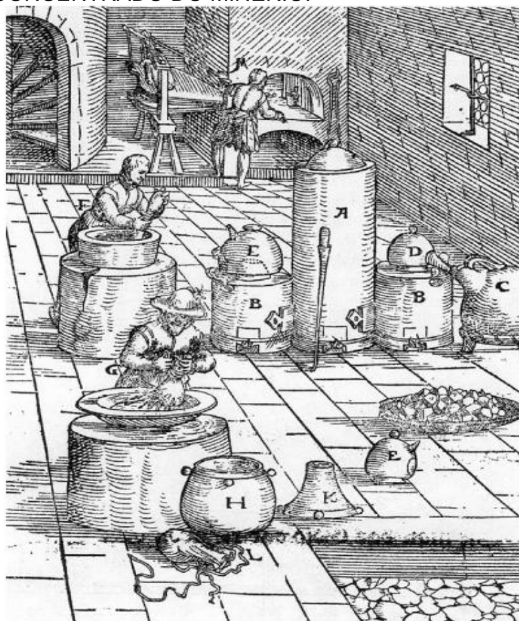
FIGURA 3: USO DO MERCÚRIO PARA DISSOLVER O OURO CONTIDO NO CONCENTRADO DO MINÉRIO.
