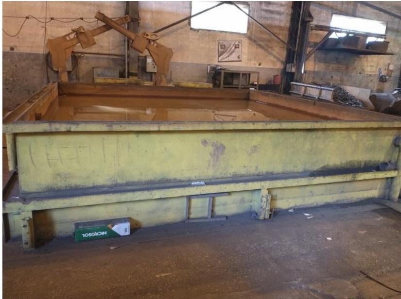
Figura 3.5 - Tanque de resfriamento
