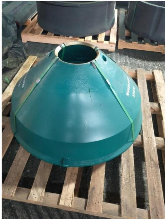
Figura 3.1 - Manto fabricada na VDL Siderúrgica Itabirito (VDL, 2022)
