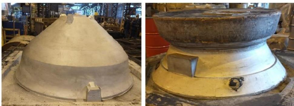
Figura 3.3 - Modelos em madeira de Mantos e Revestimentos (VDL, 2022)
