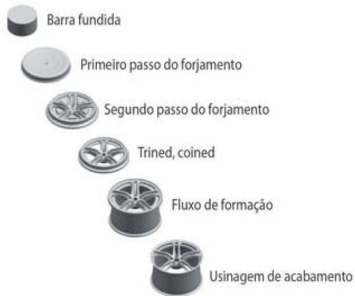
Figura 13: Etapas de forjamento de rodas de alumínio. Fonte: ABAL, 2016.
