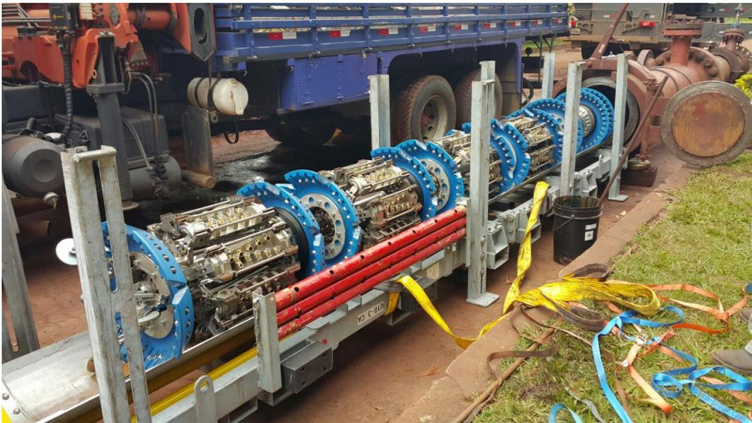
Figura 24: *Smart* PIG com tecnologia UT-C
