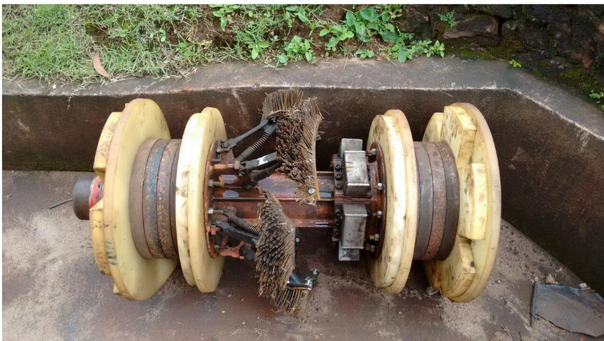
Figura 21: PIG de limpeza com escovas e imã
