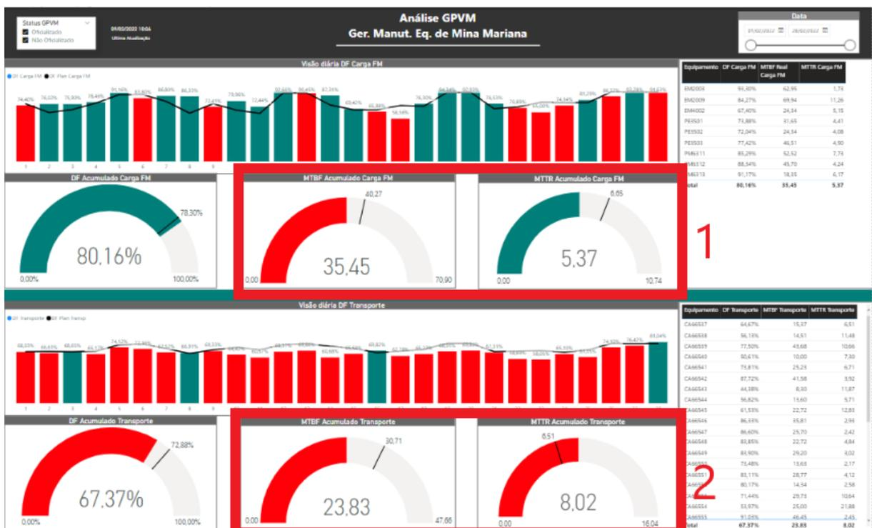
Figura 26: Painel Carga e Transp. MTBF e MTTR Carga (1) e transporte (2).
