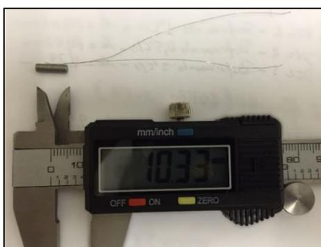
**Figura 3 - Fotografia de um corpo de prova de dilatométrica com um termopar do tipo K soldado em sua superfície.**
