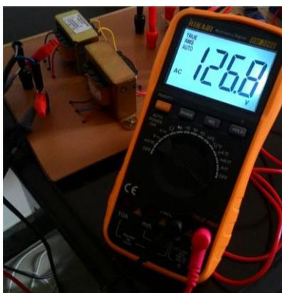
Para constatar o cálculo da potência ativa pelo medidor implementado, faz-se o cálculo da mesma com os valores obtidos pelo multímetro. Lembrando que o FP da lâmpada incandescente é 1.
