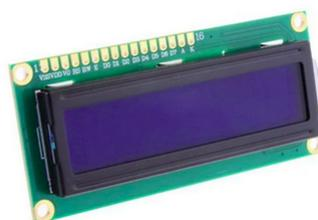
Figura 10 – Display LCD 16x2.
