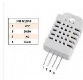
Figura 4 – Sensor DHT22.
