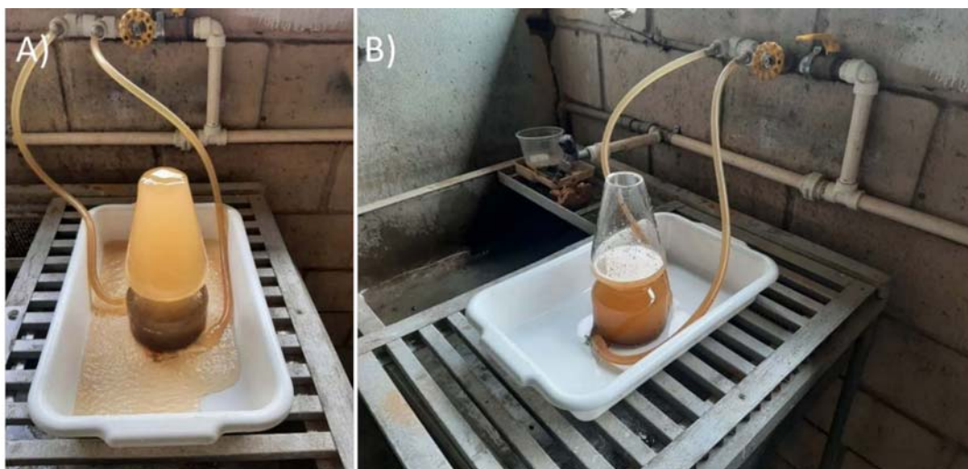
Figura 3.10. Utilização do Elutriador para remoção da fração silte/argila dos concentrados de bateia.
