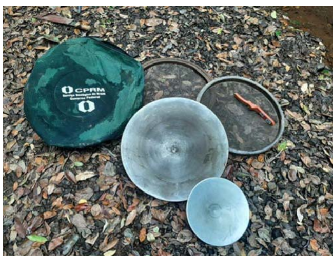
Figura 3.6. Equipamentos utilizados na coleta dos concentrados de bateia: bateias de raios de 54 cm e 30 cm, capa para as bateias, peneiras de 2mm e 1mm e escova de aço.
