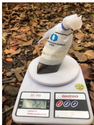
Figura 3.8. Pesagem do concentrado de bateia final em campo.
