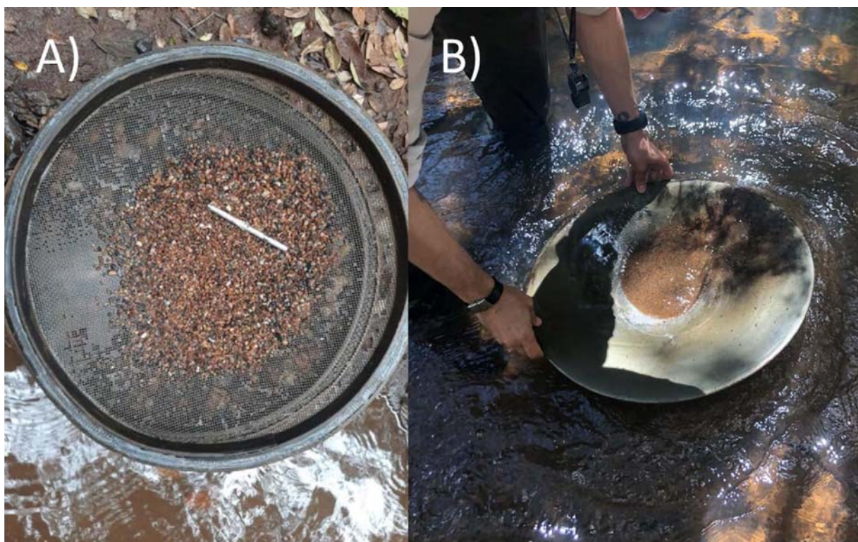
Figura 3.5. A) Segunda etapa de peneiramento (2mm) para retirada da fração ideal utilizada na bateia. B) Bateamento da fração retirada após as duas etapas de peneiramento.
