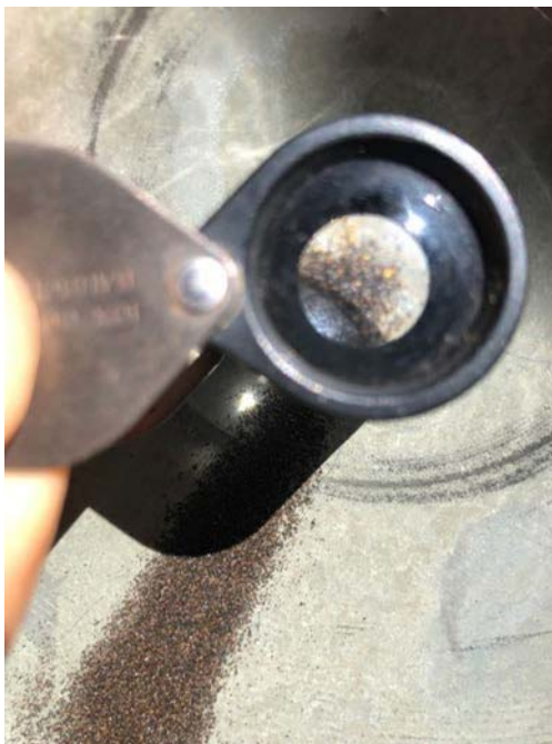
Figura 3.7. Verificação do fundo da bateia com pintas de Au, por lupa de mão com aumento de 15X.
