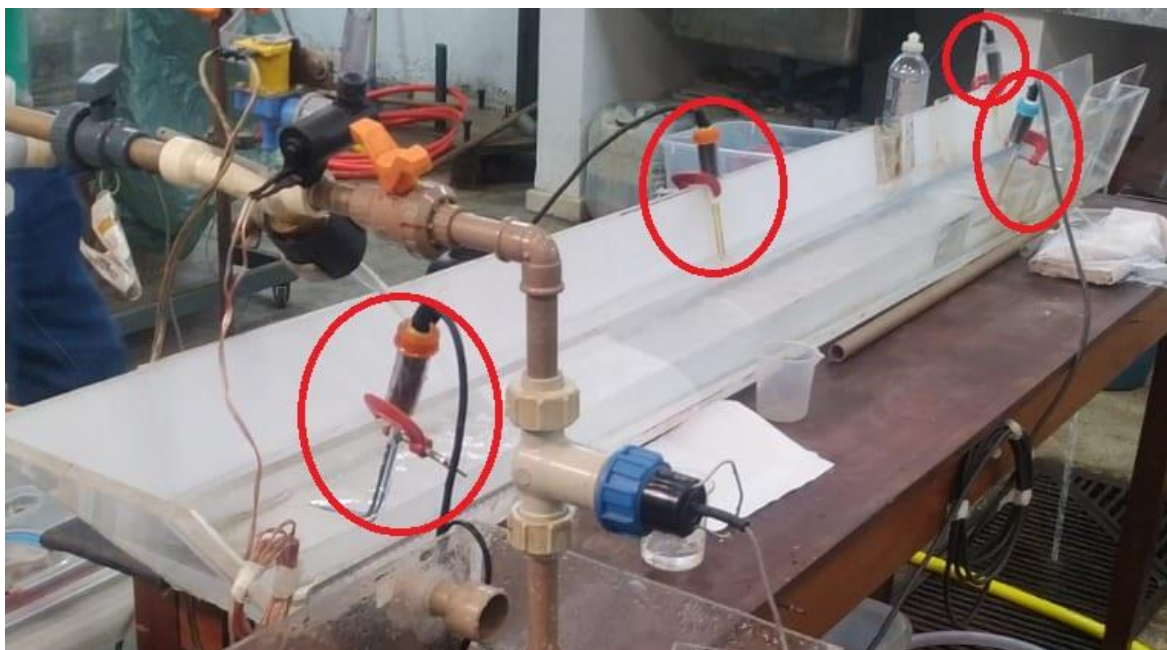
Figura 4.3 – Montagem experimental dos testes de condutimetria.
