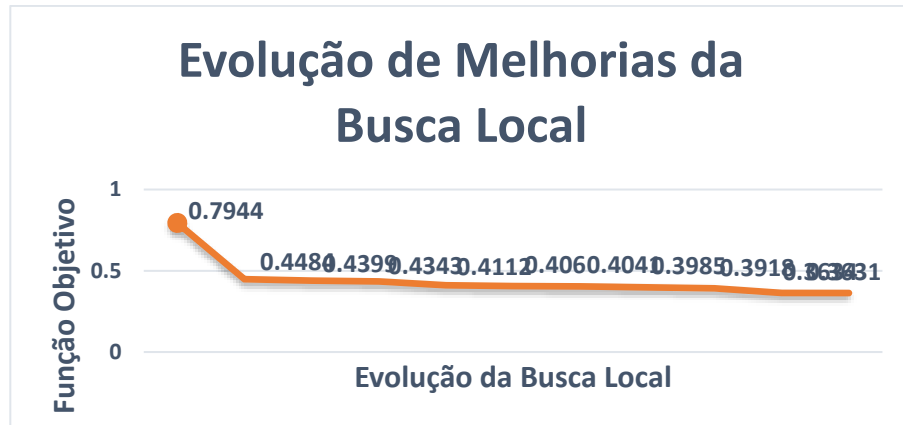
Figura 23: Evolução do processo de busca local - VNS - para obtenção do ponto de ocorrência do curto circuito.
