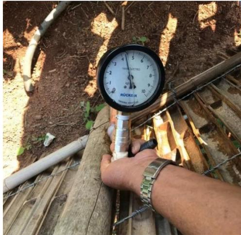
Figura 19: Medida de pressão em um ponto da rede do reservatório Soledade (AUTOR, 2019).
