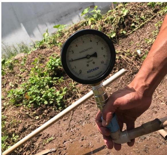
Figura 16: Medida de pressão em um ponto da rede do reservatório Tombadouro (AUTOR, 2019).
