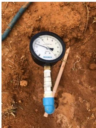
Figura 7: Exemplo de instalação do manômetro acoplado com registro na rede de distribuição de água do distrito (AUTOR, 2019).
