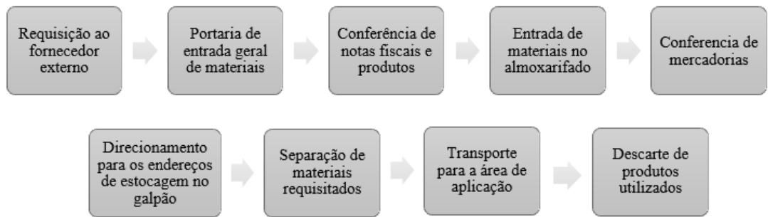
Figura 1 - Fluxo interno de materiais refratários
