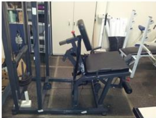
Figura 3. Aparelho extensor de joelhos (a) e potenciômetro fixo no eixo de rotação (b). Fonte: Arquivo do LAMUSC, UFMG.
