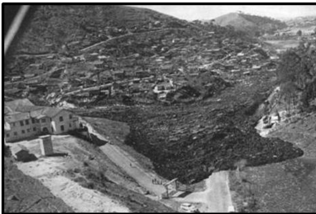
Figura 3: Vista aérea do Vale Piracuama evidenciando a movimentação do material argiloso. Fonte: Amaral & Fuck, 1973.
