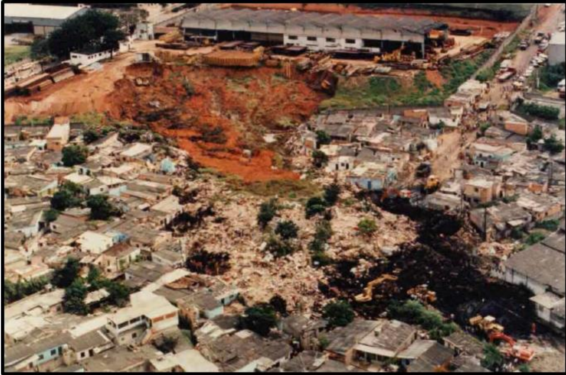
Figura 4: Vista aérea da Vila Barraginha evidenciando a movimentação do material argiloso orgânico. Fonte: CETEC, 1992.
