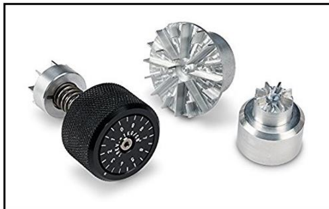
Figura 12: Dispositivo portátil Torvane e palhetas utilizadas no ensaio. Fonte: Humboldt Mfg. Co..
