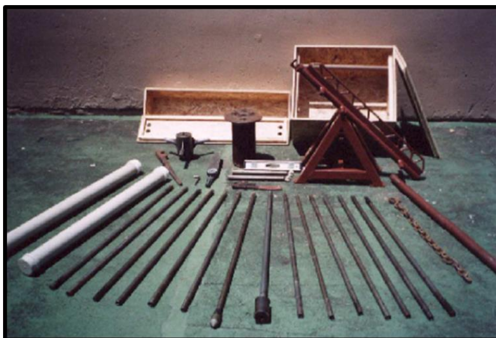
Figura 11: Equipamento DPL com hastes, martelo, plataforma niveladora, batente e ferramentas para extração do penetrômetro. Fonte: Nilsson (2004).
