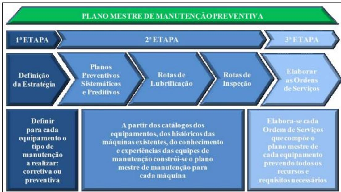
Figura 2 - Estrutura de um plano de manutenção
