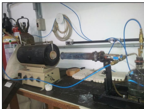
Figura 2.2. Forno elétrico a resistência do tipo tubular desenvolvido pela equipe do LTM – DEMET – EM – UFOP.
