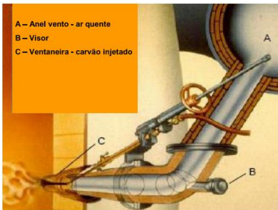
Figura 3.4: Esquema do sistema de injeção de finos pela ventaneira (ASSIS, 2014)
