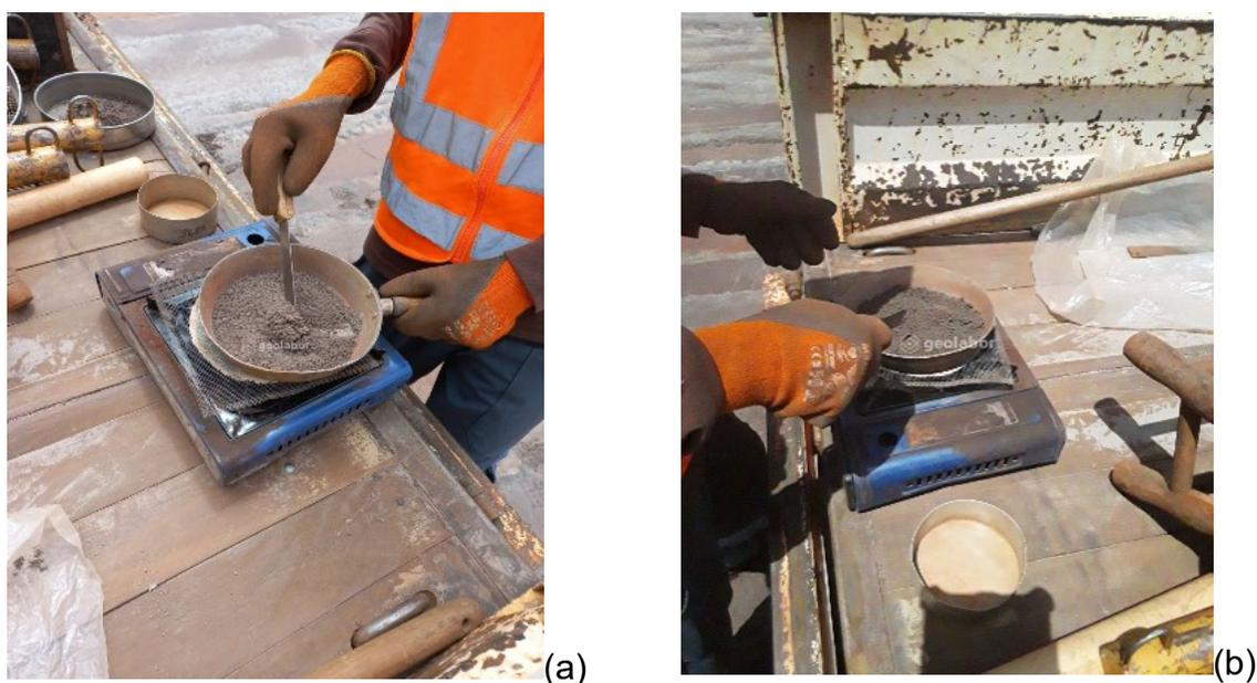
Figura 21 – a) e b): Execução do ensaio pelo método da frigideira. Fonte: Do autor.
