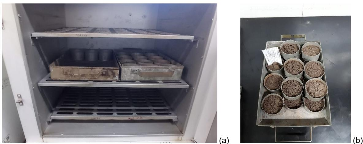
**Figura 20** – a) Execução do ensaio pelo método da estufa. b) Recipientes com rejeito para execução do ensaio. Fonte: Do autor.
