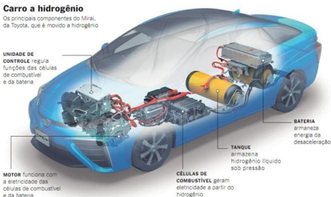
Figura 15: Principais Componentes dos Automóveis Elétricos *Fuel Cell*.
