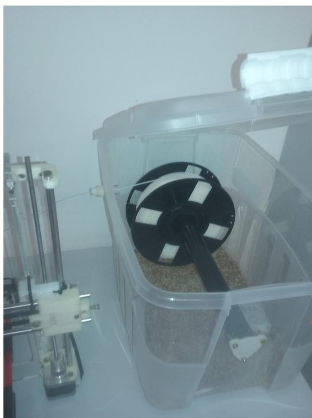
Figura 47: Caixa projetada para controle de umidade do filamento
