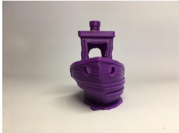
Figura 1: *Offset* de camadas causadas por distúrbios durante impressão.
