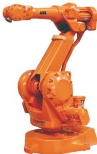
Figura 4: Manipulador robótico de 6 graus de liberdade da fabricante ABB, modelo IRB 2400.
