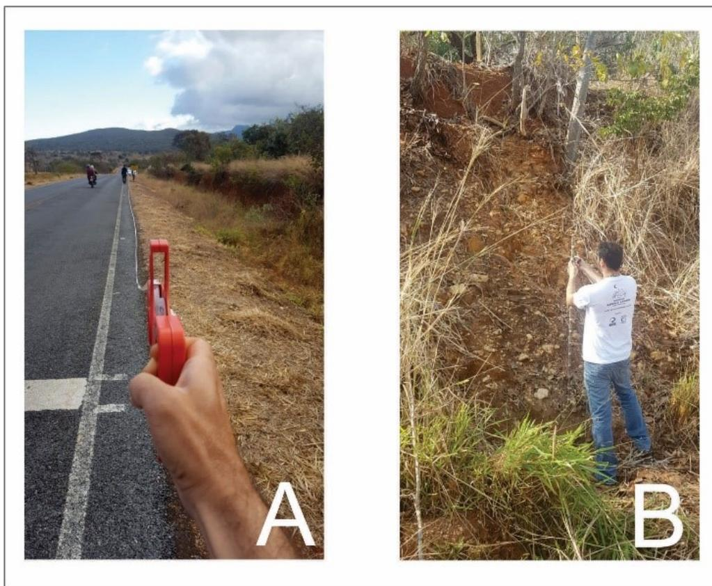
Figura 4.2: A) Medição do comprimento do perfil com trena. B) Medição da espessura do perfil com o auxílio da vara de Jacó.
