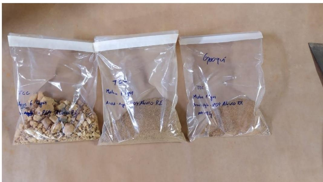
Figura 4.7: Acondicionamento do sedimento retido na peneira de 18#, passante da peneira de 18# e alíquota de 25g do passante da peneira de 18# para geoquímica.
