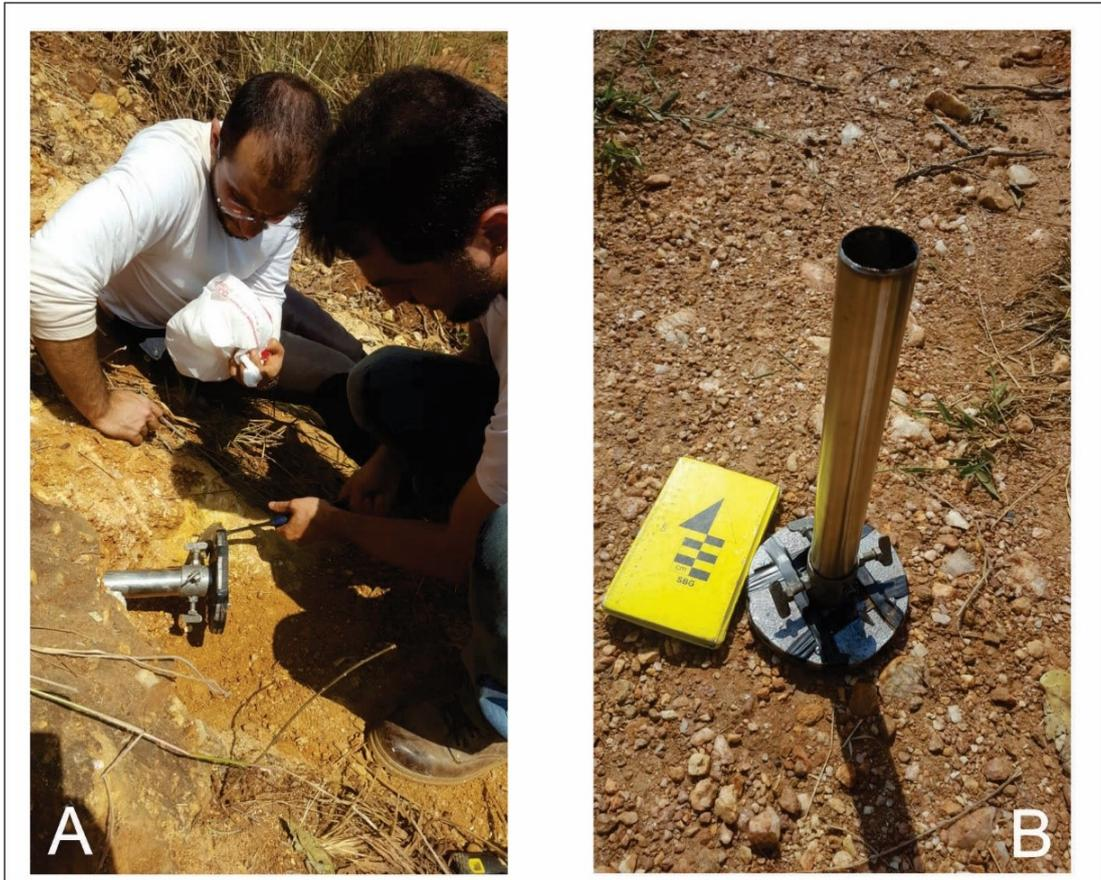
Figura 4.4: A) coleta de amostras para LOE. B) tubo de inox com base percussiva removível.
