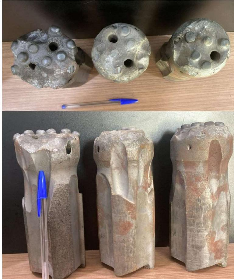
**Figura 18:** Bits danificados (caneta utilizada como escala).
