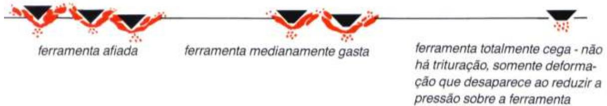
**Figura 11:** Influência do desgaste dos botões na desagregação da rocha. **Fonte:** Sandvik - Manual de Perfuração de Rochas.
