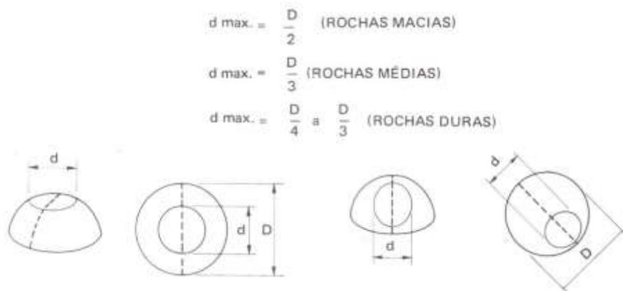
**Figura 13:** Relações entre o diâmetro do achatamento produzido pelo desgaste (d) e o diâmetro dos botões (D) para afiação. **Fonte:** Castro e Parras (1986).
