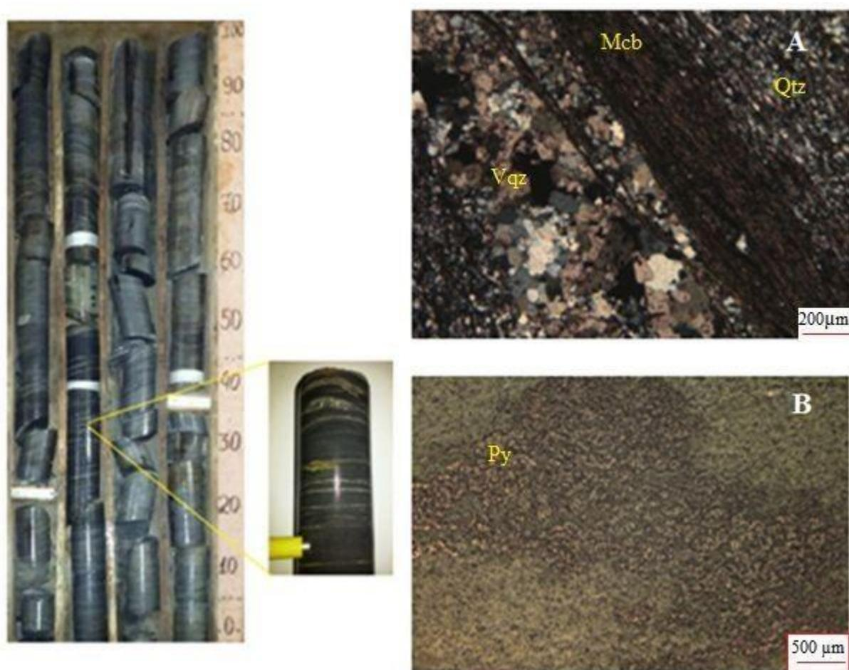
**Figura 5.3** Mica branca- quartzo xisto com sulfetação e veio de quartzo associado. À esquerda trecho representativo do litotipo. Em detalhe ao centro trecho com sulfetação e veio de quartzo. Em **A** (luz transmitida, polarizadores cruzados) com ocorrência de veio de quartzo acompanhando a foliação. Vqz - veio de quartzo, Py - pirita, Qtz - Quartzo Em **B** (luz refletida) mostrando grão centimétrico de pirita.
