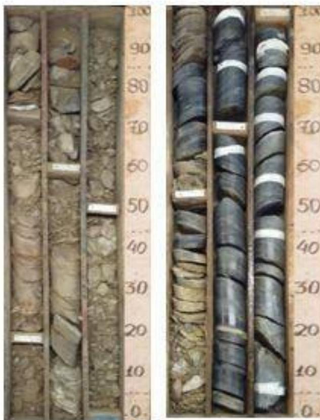
**Figura 5.2** Ocorrência de saprólito. À direita evidencia-se a transição da saprólito para a rocha sã.
