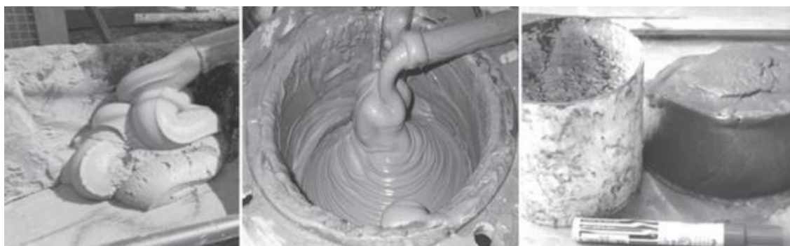
Figura 8 Consistência da pasta mineral (Osório et al., 2008 apud De Lara, 2011).
