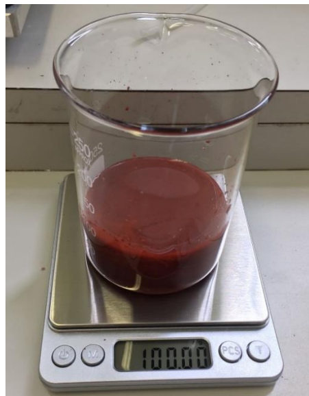
Figura 22 – Preparação da lama abrasiva em uma balança de precisão. Fonte: Pesquisa Direta (2021).
