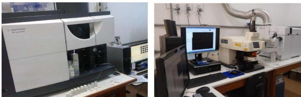
**Figura 1.10** - Espectrômetro de emissão óptica com plasma indutivamente acoplado (ICP-OES) – Agilent 725 à esquerda. Espectrômetro de massas com plasma indutivamente acoplado (ICP-MS) – Agilent 7700x. à direita. Fonte: Nogueira (2018).
