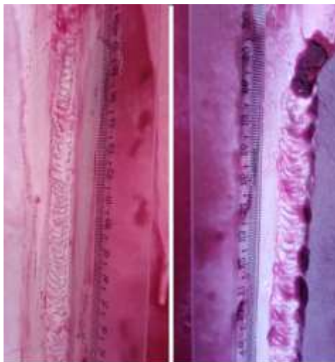
Figura 22: Revelação após tempo de aplicação. Fonte: Pesquisa direta, (2021).
