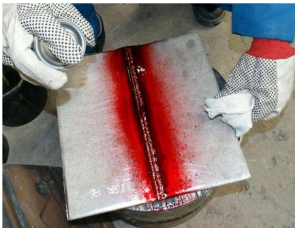
Figura 8: A qualificação para o ensaio por líquido penetrante. Fonte: Prado Filho, (2016).
