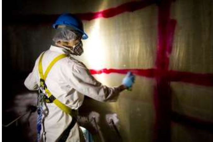
Figura 3: Inspeção da estrutura de um equipamento metálico utilizando técnicas de análise não destrutivas.
