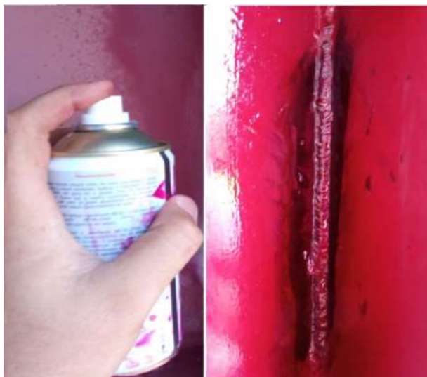
Figura 20: Aplicação do líquido penetrante. Fonte: Pesquisa direta, (2021).
