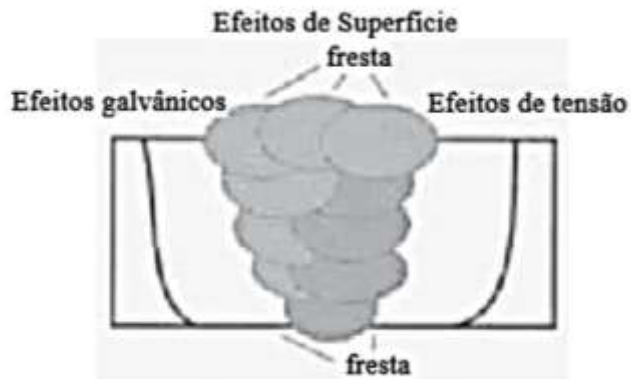
Figura 6: Diferentes tipos de efeitos presentes em juntas soldadas, que as tornam locais preferenciais de processos corrosivos. Fonte: Zeemann, (2003).
