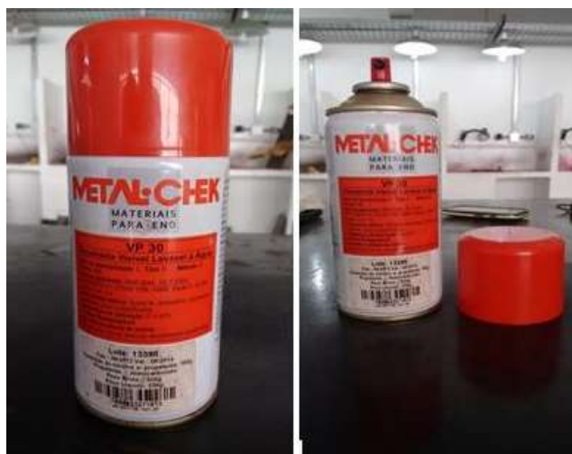
Figura 15: Penetrante visível lavável a água. Fonte: Farias, (2014).
