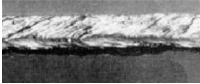
Figura 30: Exemplos de indicações patológicas encontradas em juntas soldadas. Em mordedura
