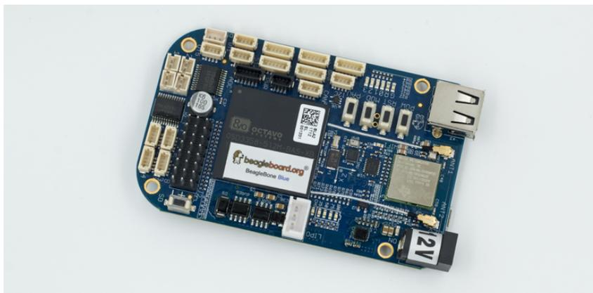
Figura 1 – Configuração de uma placa embarcada BeagleBone Blue.
