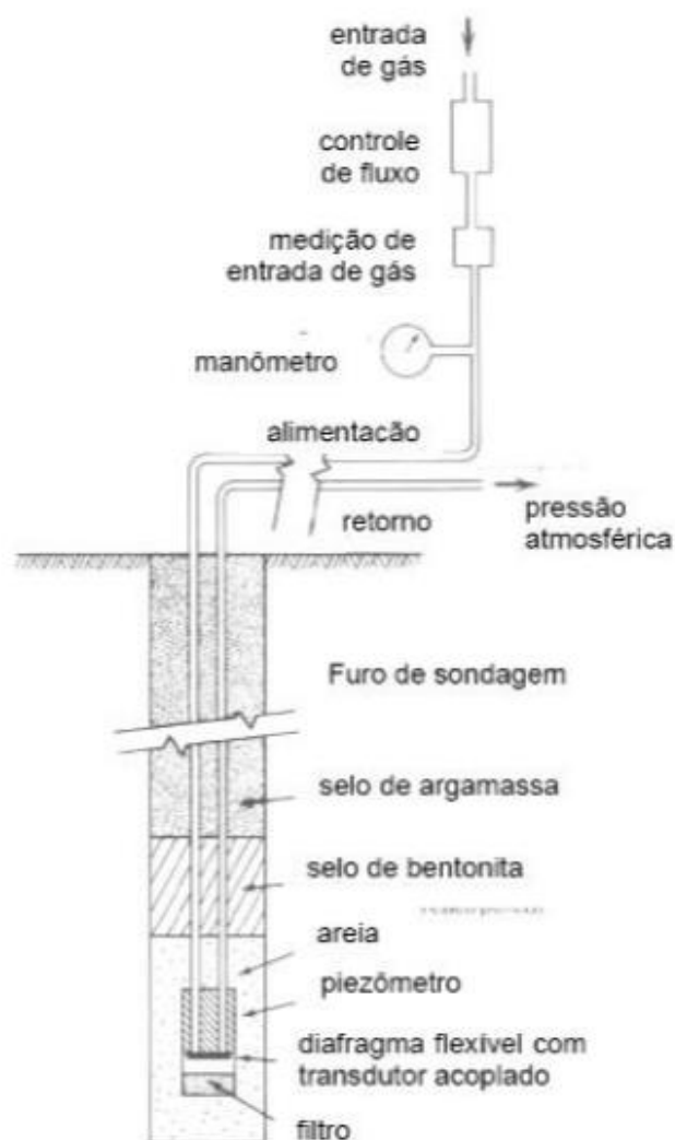
Figura 6: Piezômetro pneumático Fonte: Dunncliff (1988)
