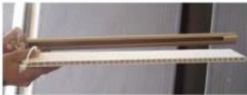
Figura 9 - Placa de forro PVC e tubo de PVC cortado Fonte: Sociedade do Sol (2009)
