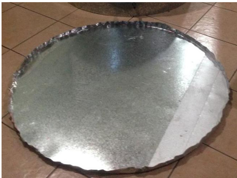
Figura 33 - Chapa de Aço Galvanizado da Parte Inferior do Reservatório Fonte: Pesquisa direta (2015)
