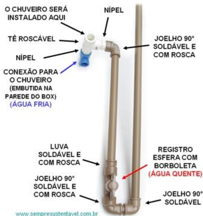
Figura 39 - Esquematização do Misturador com PVC Fonte: Urbano (2012)
