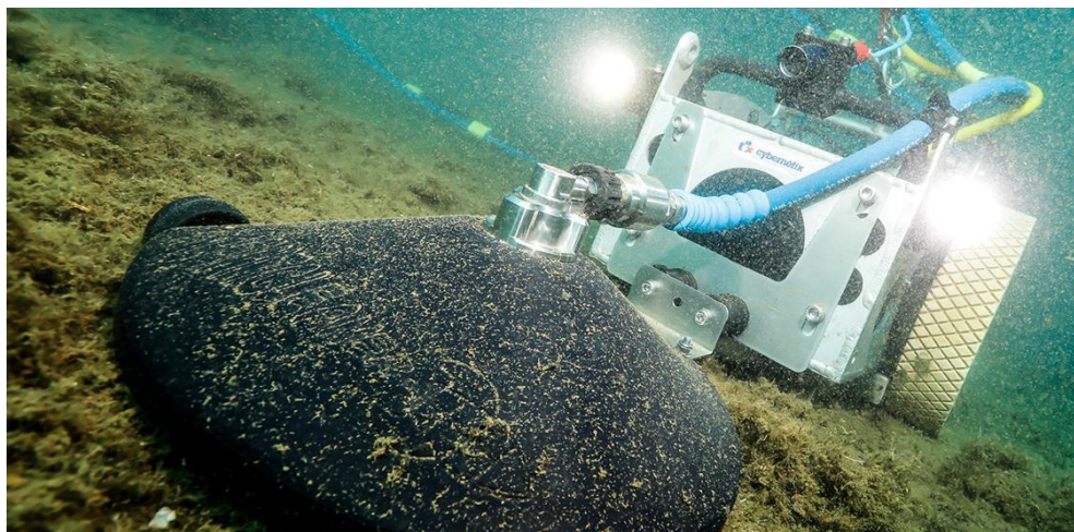
Figura 35: Magnetic Hull Crawler realizando inspeção.
