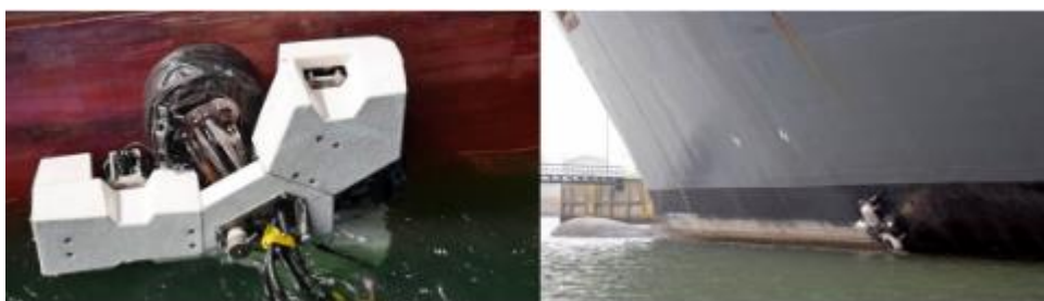
Figura 15: Exemplo de ROV utilizado para limpeza de grandes embarcações.
