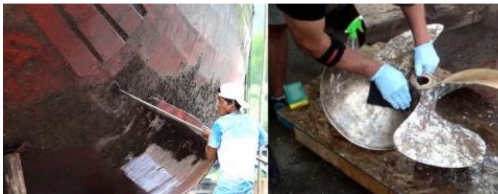
Figura 12: Bioincrustação sendo removida manualmente através de raspadores.
