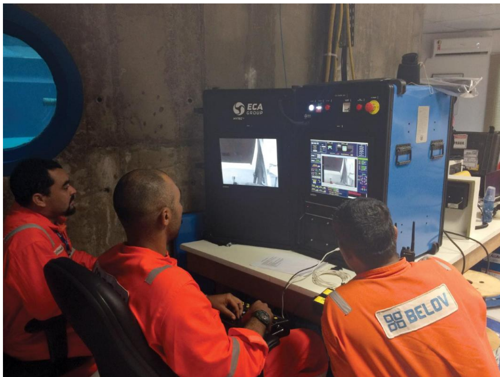
Figura 40: Estação de controle do RovingBAT
