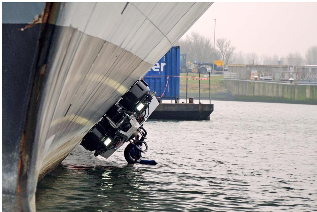
Figura 24: Fleet Cleaner aderido ao casco de um navio.
