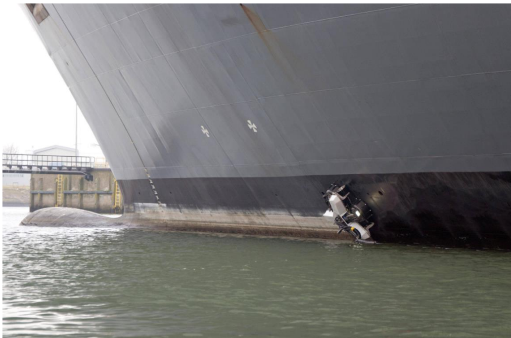
Figura 25: Fleet Cleaner realizando a limpeza do casco de um navio.
