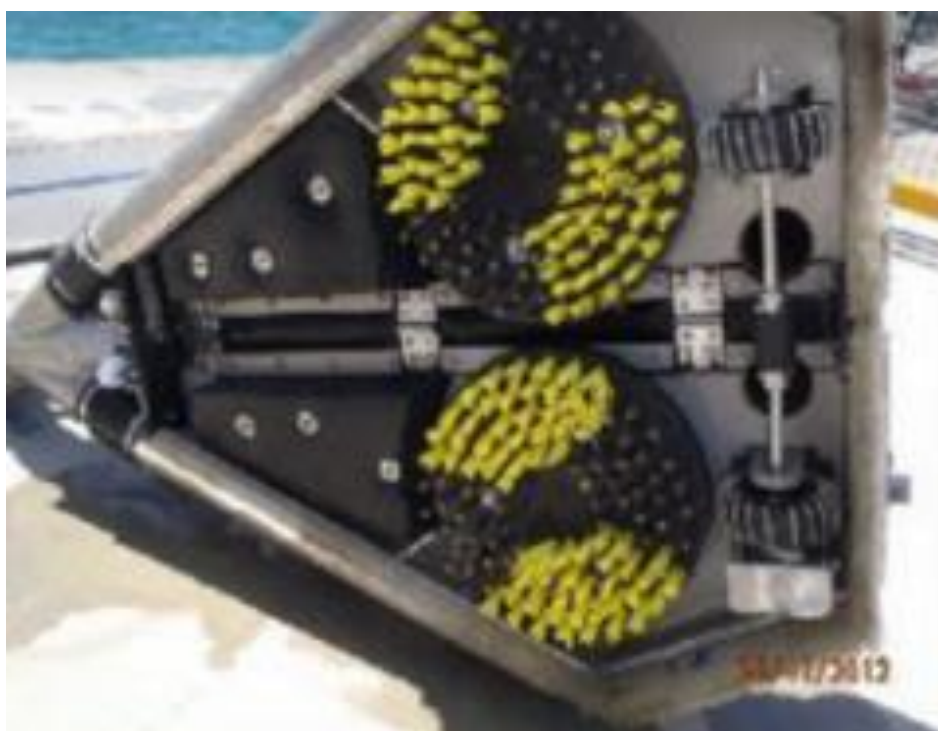
Figura 16: Ferramenta Envirocart equipada com escovas rotativas.
