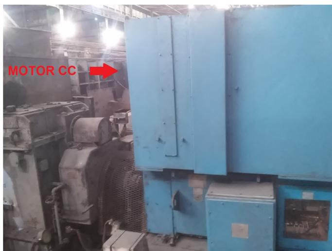
O motor é responsável pela movimentação do mecanismo de uma tesoura de corte de material laminado quente.
