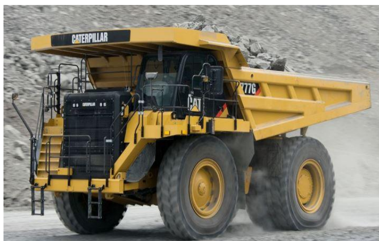
Figura 15: Caminhão fora de estrada. Fonte: Caterpillar (2012).
