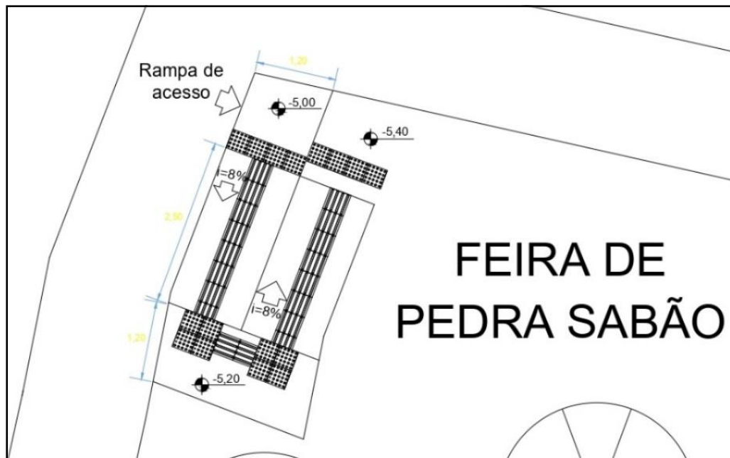
Figura 25: Rampa de acesso à feira de pedra sabão
