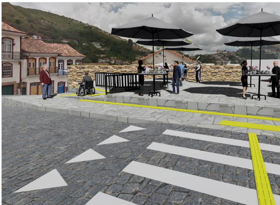
Figura 27: Detalhamento do piso tátil e passarela elevada. Fonte: Desenvolvido pela autora.
