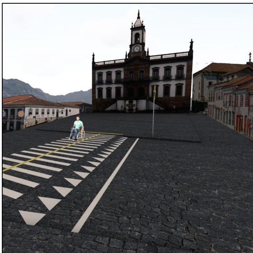
Figura 34: detalhamento passarela elevada para pedestre. Fonte: desenvolvido pela autora.
