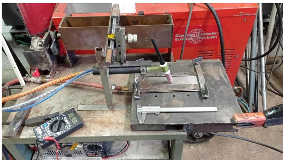
Figura 4.2 - Dispositivo de soldagem GTAW mecanizado utilizado na soldagem autógena de uma chapa de aço DP 980 (próprio da autora).
