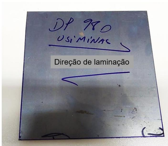
Figura 4.1 - Chapa de aço DP980 que foi submetida à soldagem GTAW autógena (próprio da autora).
