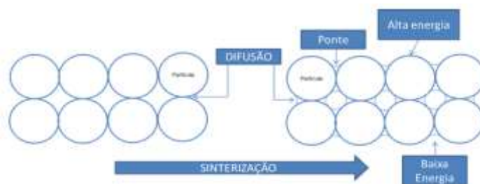
Figura 3.9: Desenho esquemático do fenômeno de sinterização.
