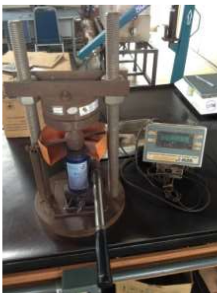
Figura 3.44: Máquina utilizada para determinação da resistência a compressão.
