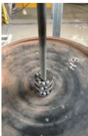
Figura 3.50: Suporte para pelotas usado no ensaio de FSI.
