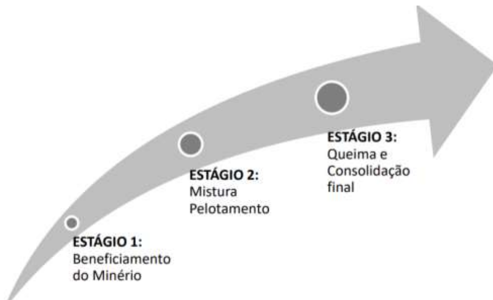
Figura 3.1: Estágios de tratamento do minério de ferro, visando à produção de pellets.
