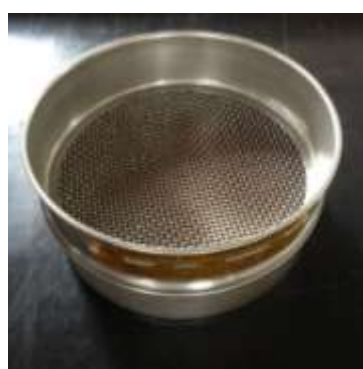
Figura 3.48: Peneira com abertura de 2,8mm utilizada no teste de RDI.
