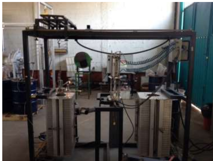
Figura 3.49: Forno utilizado nos testes de RI, RDI e FSI.
