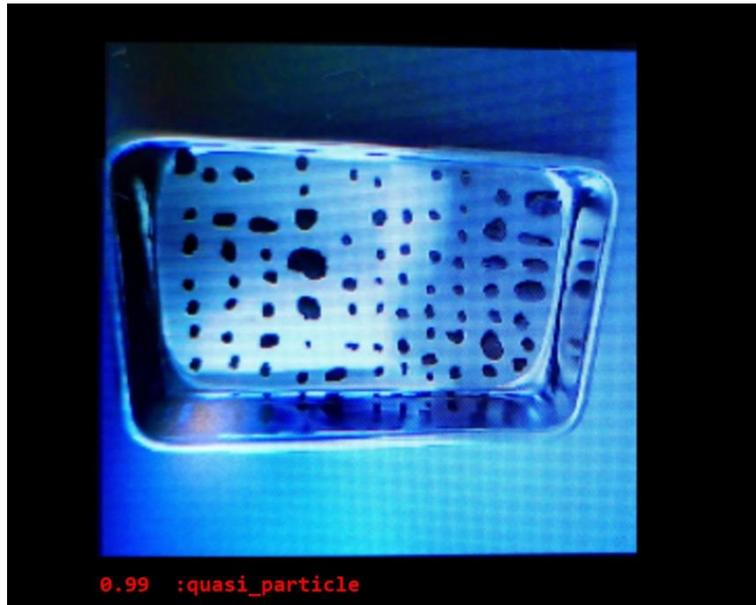
**Figura 10** - Exemplo de reconhecimento de quase-partículas com amostra desenvolvida em escala de bancada durante o teste usando SiPEED (própria autora)
