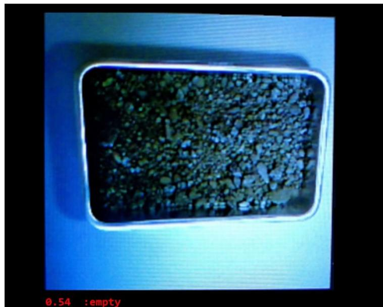
**Figura 9** - Exemplo de erro no reconhecimento de quase-partículas simulando amostragem em um ambiente industrial durante o teste usando SiPEED (própria autora)
