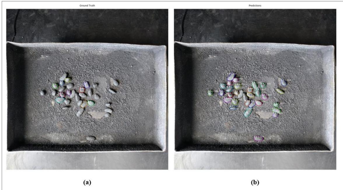
**Figura 17** - Exemplo de imagem contendo partículas da classe '8-9' do treinamento 4. Em a) as partículas em destaque representam as partículas rotuladas e calculadas como verdade fundamental (*ground truth*), e em b) as partículas em destaque representam as partículas encontradas pelo modelo na predição (*predictions*) (própria autora)
