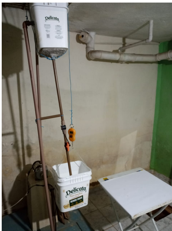
Figura 20 – Sistema montado para calibração do transdutor.
