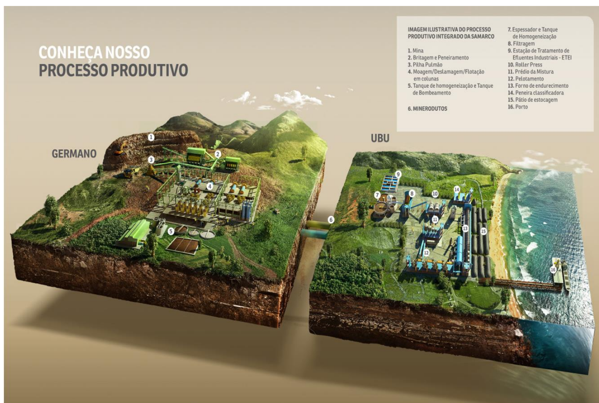
Figura 3.5 – Fluxograma ilustrativo do processo produtivo integrado da Samarco Mineração S.A. (extraído da apresentação institucional aos acionistas da empresa).
