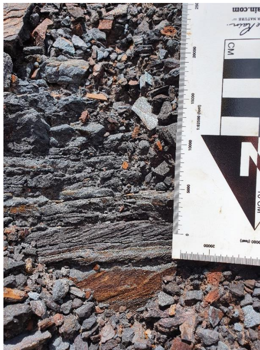
Figura 4.5 - Foto tirada em campo do afloramento de Itabirito Especularítico-Martítico (IEM) com forte marcação da foliação e dos planos de interseção, que formam “chapinhas”.
