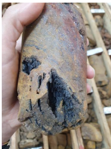
Figura 3.3 – Furo de sondagem de um IG com feições de estalactites (foto autoral 2020).
