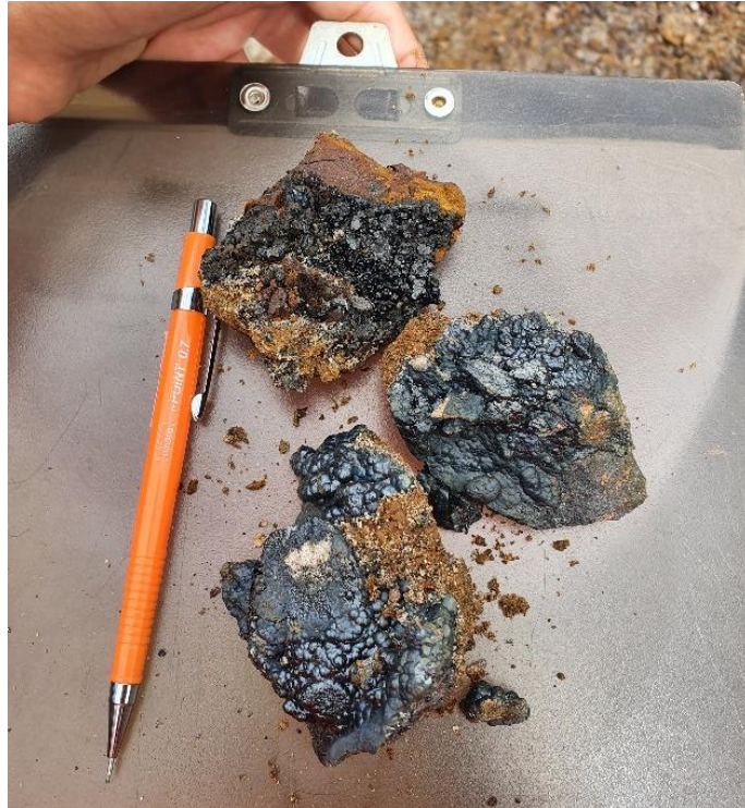
Figura 4.7 - Amostras de afloramento de Itabirito Goethítico com textura botrioidal.
