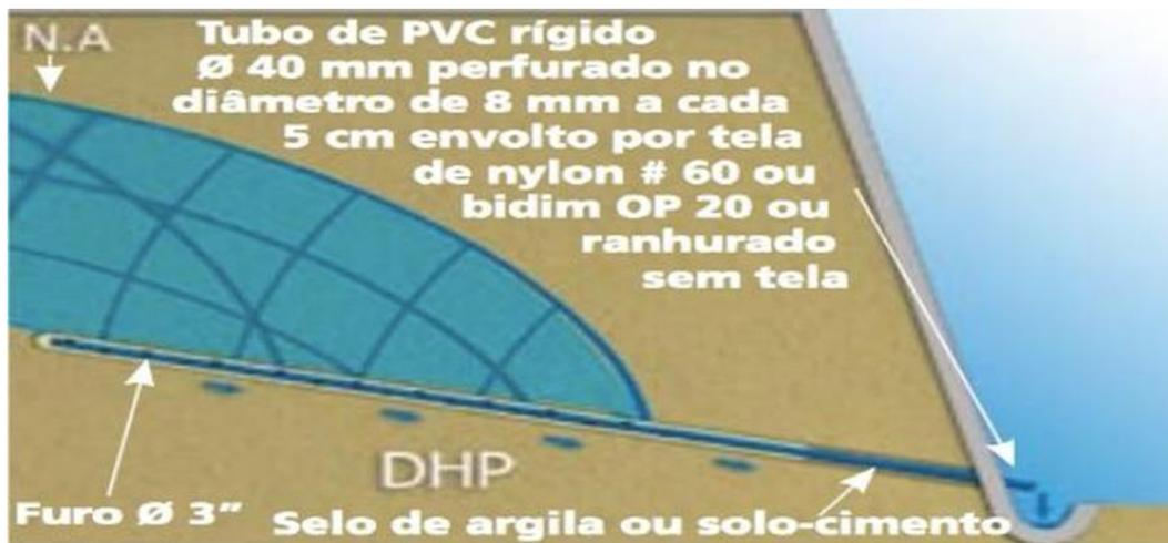
Figura 13 - Exemplo de dreno horizontal profundo
