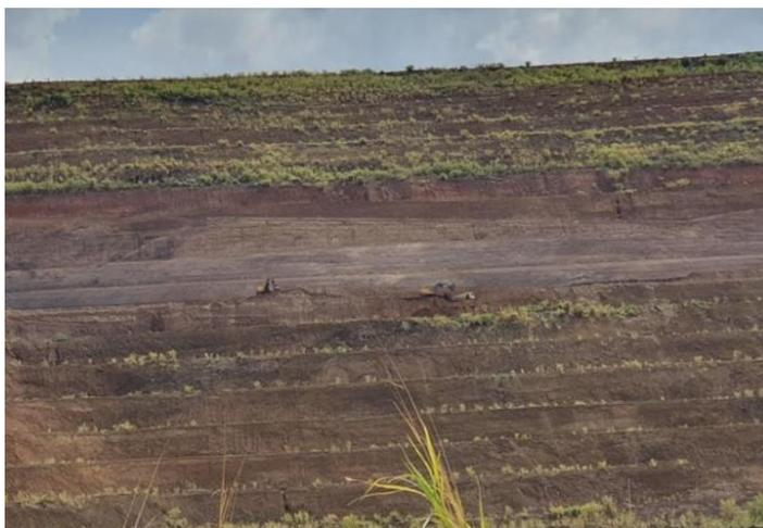
Figura 17: Operação de remoção de estéril nos bancos 1060 m e 1050 m
